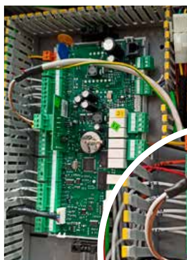
⑤b Detail Verbindung Platine µPC BMS
