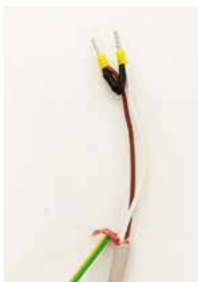
④ Kabel-Verbindung gelb - grün - Kabelschirm
